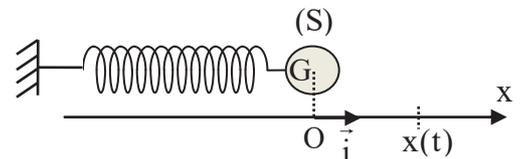
On choisi la position  $x = 0$  de G (ressort non allongé) comme référence de l'énergie potentielle élastique  $E_{pe}$  et le plan horizontale passant par G comme référence de l'énergie potentielle de pesanteur.
