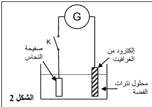
عند إغلاق قاطع التيار K ، يزود المولد G الدارة خلال المدة  $\Delta t = 45 \text{ min}$  بتيار كهربائي شدته ثابتة  $I = 0,5 A$  ، فيتصاعد غاز ثنائي الأوكسجين  $O_2$  على مستوى إلكترود الغرافيت ويتوضع فلز الفضة بشكل منتظم على الإلكترود الآخر.
