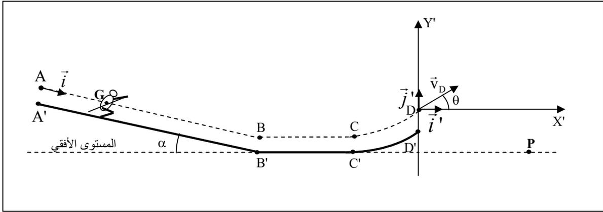
ننمذج الرياضي ولوازمه بجسم صلب (S) كتلته  $m = 65 \text{ kg}$  ومركز قصوره  $G$ ، ونأخذ  $g = 10 \text{ m.s}^{-2}$ . يمر  $G$  أثناء حركته من المواضع  $A$  و  $B$  و  $C$  و  $D$  المبينة في الشكل، حيث  $A'B' = AB$  و  $B'C' = BC$ .
