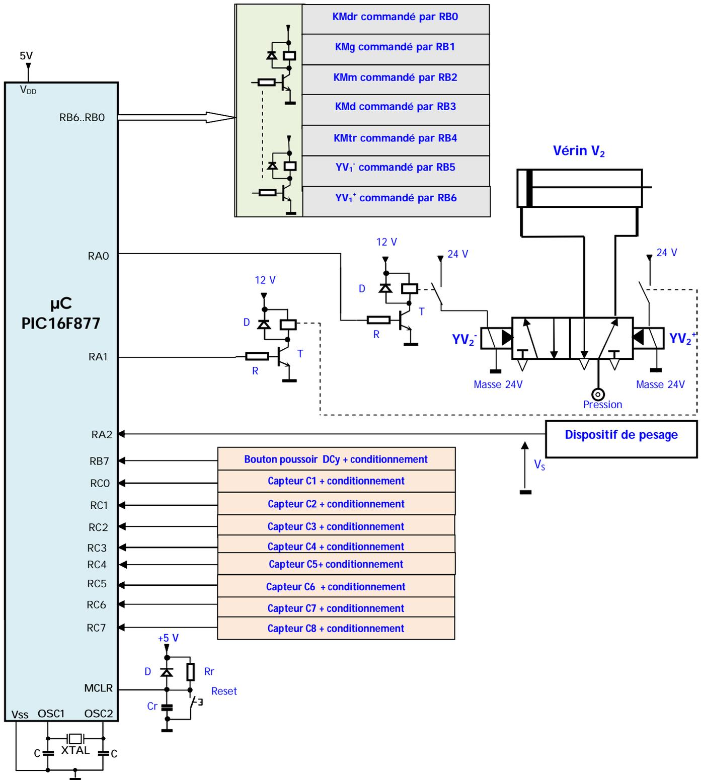
Les distributeurs pilotant les vérins  $V_1$  et  $V_2$  sont identiques et leur commande est de type bistable.
