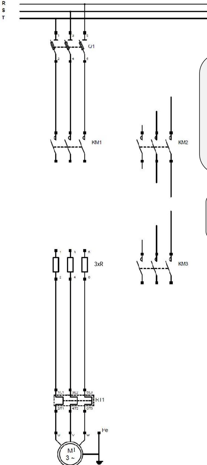
Le démarrage par élimination de résistances statoriques s'effectue en deux temps :
