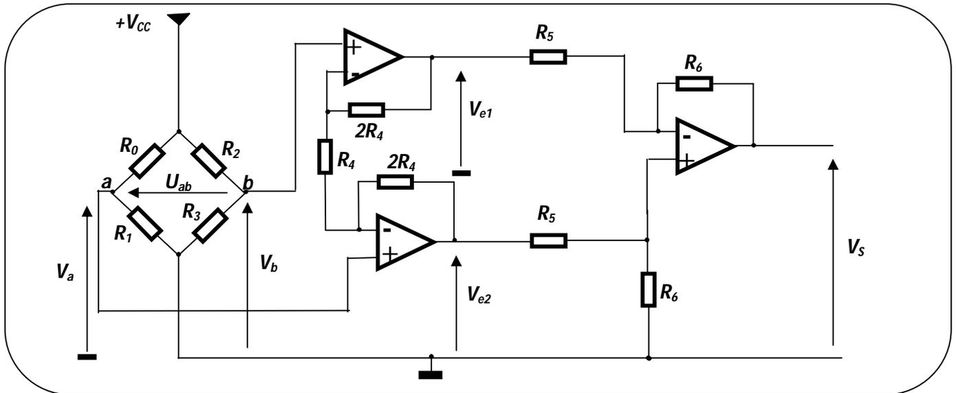
Les résistors  $R_2$  et  $R_3$  ont des résistances fixes insensibles aux déformations et leur valeur est  $R_2 = R_3 = R = 5 \text{ k}\Omega$ , tandis que les résistors  $R_0$  et  $R_1$  sont des capteurs de contrainte de même valeur que  $R$  lorsqu'il n'y a aucune masse à mesurer et ils changent de valeur sous l'action de la masse.
