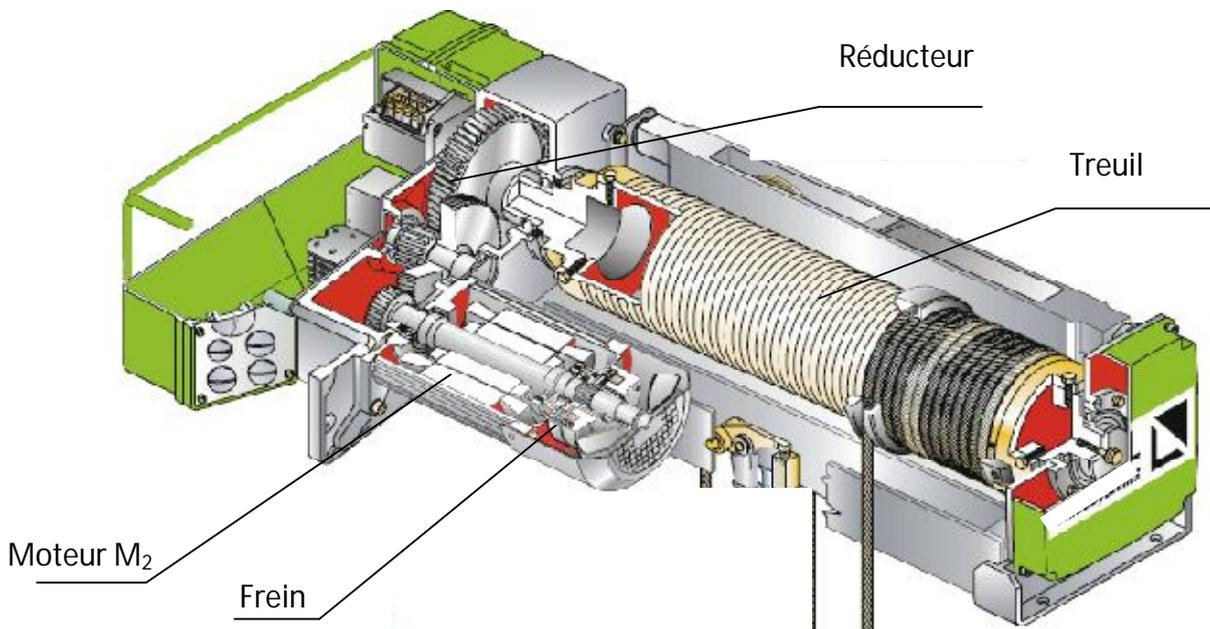
Le moteur du treuil de la benne est muni d'un frein électromagnétique à manque de courant, monté à l'arrière du moteur. Ce frein (voir dessin d'ensemble partiel) se compose de :
