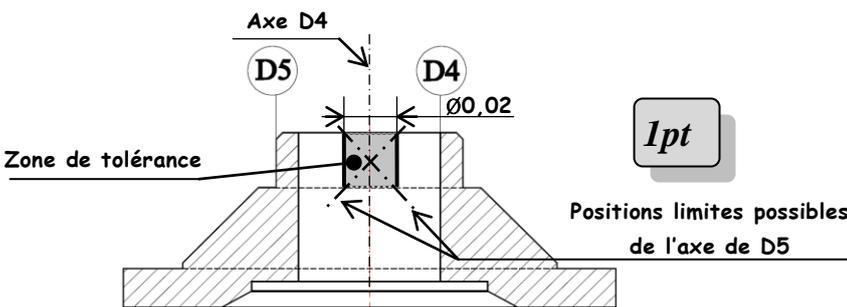
*L'axe du diamètre D5 doit être compris dans une zone cylindrique de  $\varnothing$ 0,02 et coaxiale à l'axe du cylindre de référence D4.*
