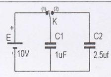
On bascule l'interrupteur en position 1 puis on le fait passer en position 2. Déterminer :
