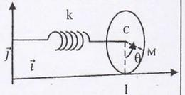
On suppose que le contact au point I s'effectue avec frottement et sans glissement.
