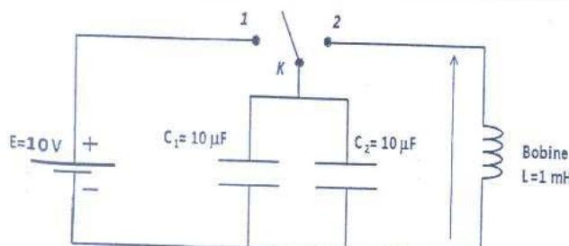
تحتبر التركيب الممثل في الشكل جانبه . نغلق قاطع التيار  $K$  بالموضع 1 لنشحن المجموعة المكونة من التمكثف  $C_1$  والمكثف  $C_2$  ، تحت توتر  $E$  .
