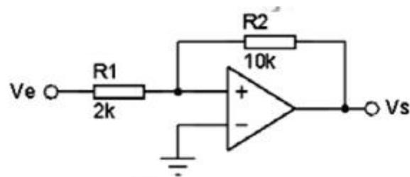
1. Déterminer la tension à l'entrée (+) et la tension à l'entrée (-) de l'amplificateur opérationnel.
