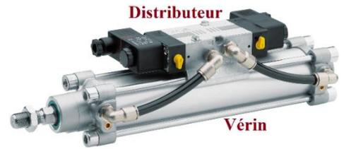
Le distributeur abrite une partie mobile appelée tiroir qui, sous un ordre de commande, se déplace pour fermer et ouvrir des orifices de fluide et ainsi piloter les différents états d'un vérin.
