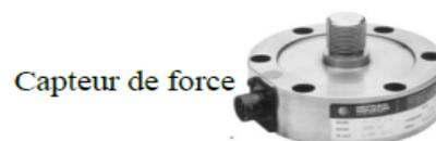
Ce capteur comporte 4 jauges de contrainte identiques montées en pont de Wheatstone (figure ci-contre).
